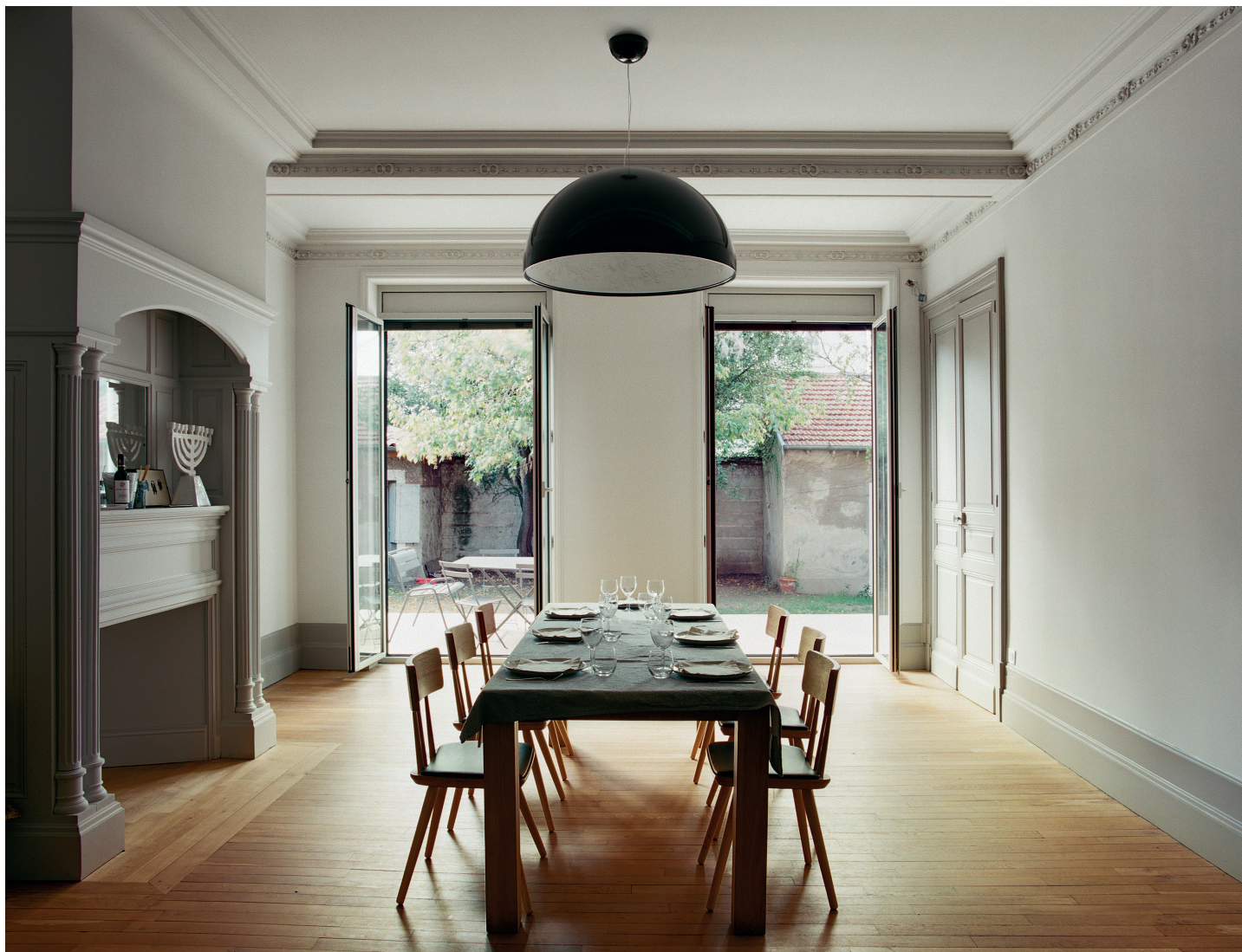
Vue sur la terrasse depuis la salle à manger. Le parquet existant a été poncé puis vitrifié. La cheminée d'époque, les murs et les plafonds ont été repeints dans la teinte Cornforth White No. 228 de Farrow & Ball et les plinthes en Chemise No. 216.
